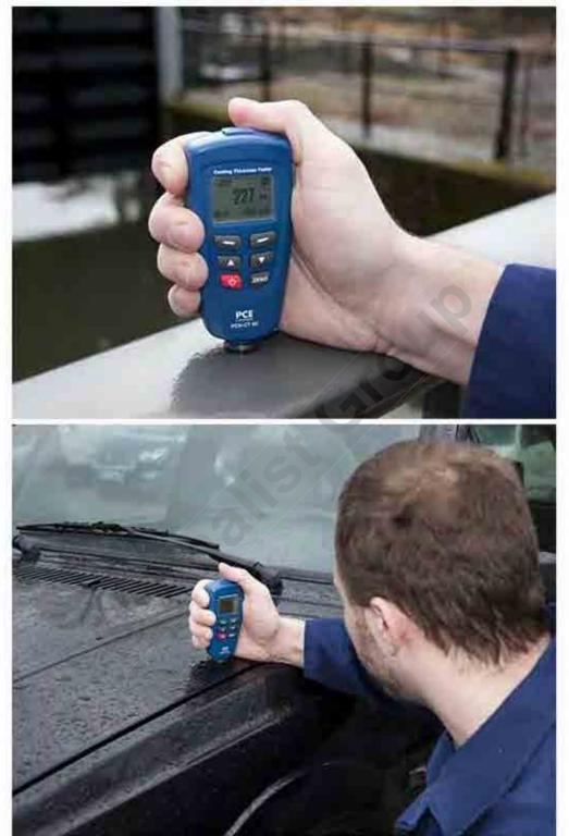
Collocare il misuratore di spessore sulla parte da misurare e leggere il valore sul display. Si misura tanto facilmente il rivestimento di smalti, lacche, zincati, ecc., o metalli come acciaio, acciaio inox, ferro, metalli non ferrosi e alluminio anodizzato.
